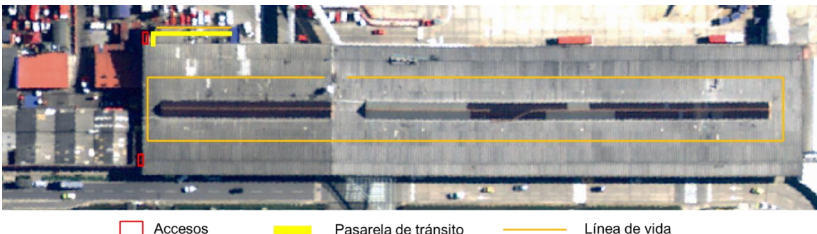
Ilustración 3. Accesos a cubierta T2
