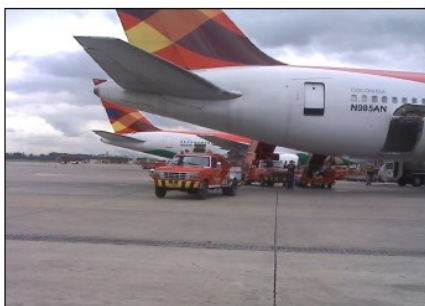
1) Arribo del vehículo, ubicación debajo del sitio de descarga de excretas y carga de Blue Water
