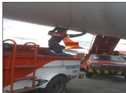
4) Verificación de llaves de entrada y salida de vehículo y aeronave
