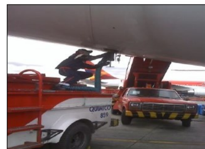
5) Instalación de manguera de evacuación de excretas
