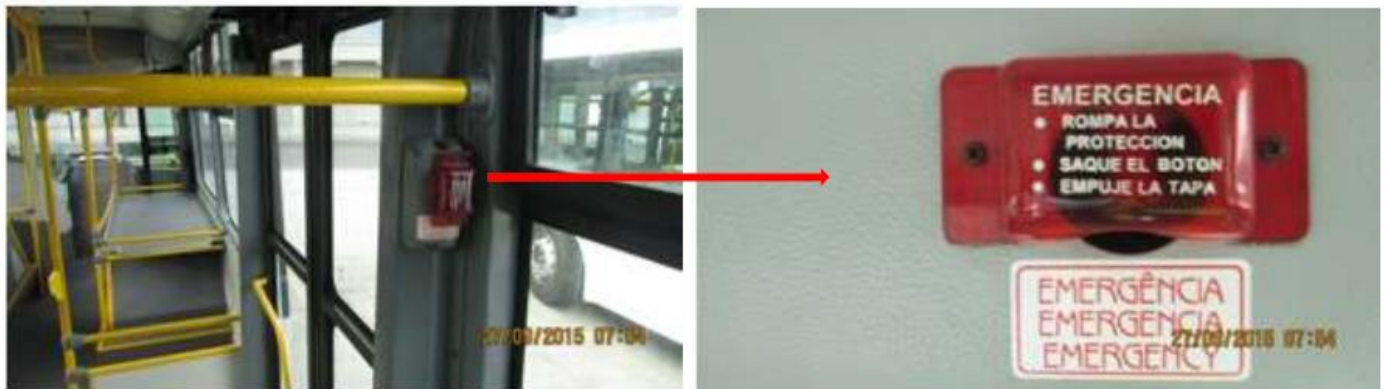
Figura 2 Sistema de apertura de emergencia
